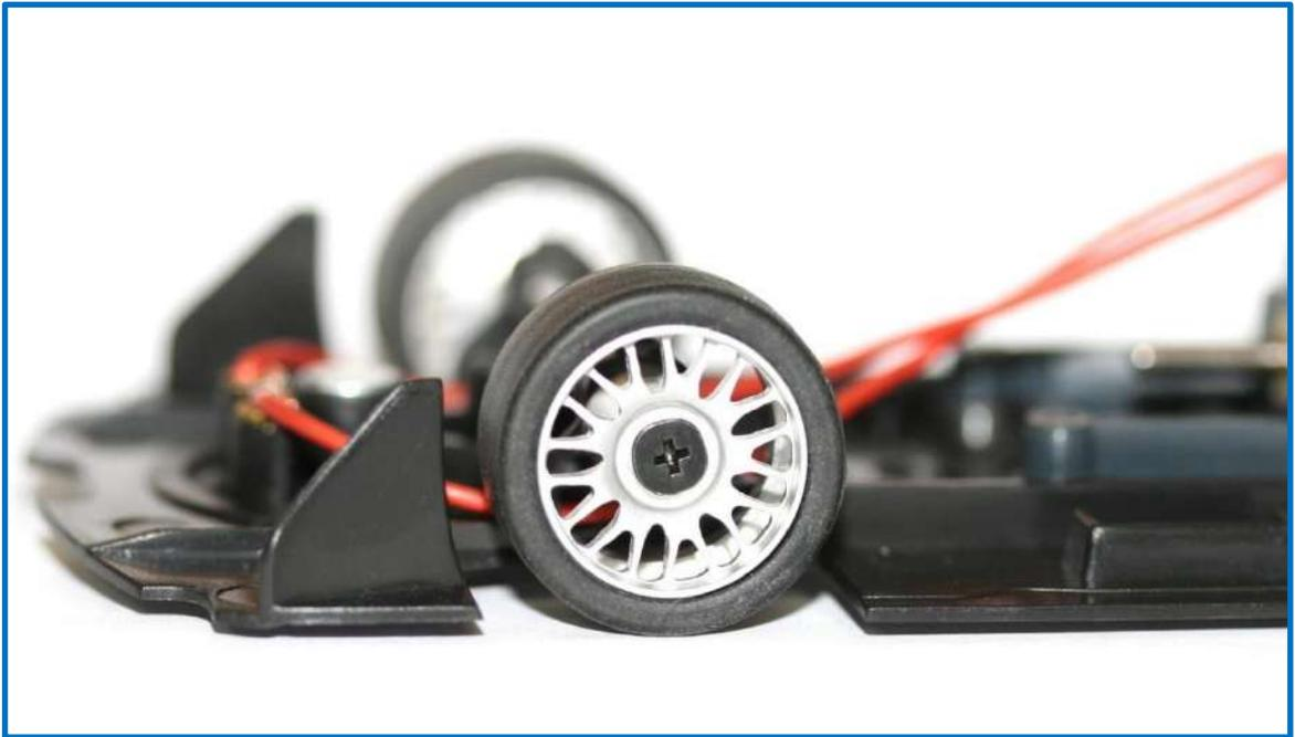
En esta preparación la rueda gira “libre” sobre el semieje pegado y el tornillo Phillips, lógicamente, evita que la llanta se salga. A este tipo de eje se le denomina **-eje RÍGIDO para ruedas independientes-**
