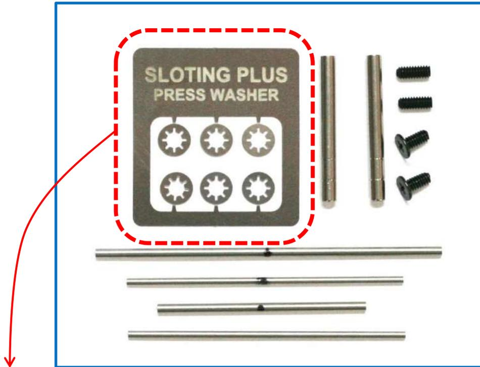
Las arandelas estriadas se pueden colocar en cualquiera de las ranuras que incorpora el semieje y su función es la de impedir el movimiento longitudinal del semieje, es decir, actúa igual que lo haría un tope o prisionero para la corona (Stopper) pero con mucho menor peso (0,02 gr.), ninguna inercia y muy sencillas de montar.
