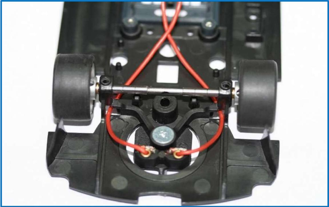
Para este ejemplo, el tubo que une solidariamente los dos semiejes **-SÍ-** está pegado, es de  $\text{Ø}1,4 \times 30$  mm. de longitud y las llantas **-NO-** tienen el espárrago allen.
