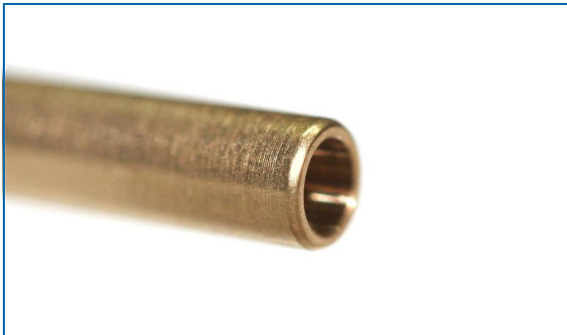
Como podrá observar, los extremos del tubo están debidamente redondeados para facilitar su introducción en las bancadas pero aún y así, algunos soporte de motor necesitarán eliminar las rebabas que, en algunas ocasiones, se producen en la inyección del plástico por un cierre poco ajustado en el molde o por una sobrepresión en la inyección del material.
