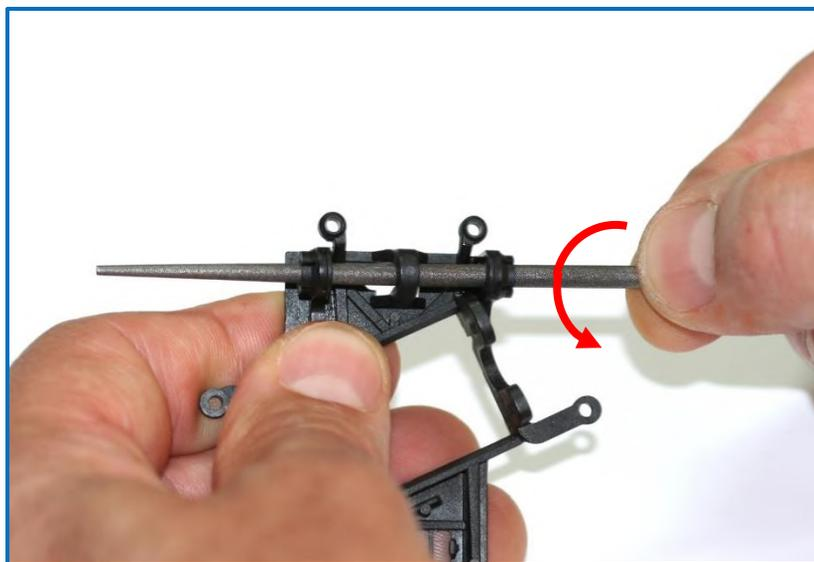
Cuando ya pueda introducir el tubo COMBI PLUS MONOBLOCK en ambos extremos de la bancada será el momento de montarlo ayudándose de una llanta montada en un eje + un **separador de 0,20 mm.** de espesor tal y como se muestra en la foto inferior.
