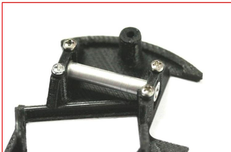
Si utiliza cojinetes del tipo UNIVERSAL de Bronce, Latón, Nylon o Aluminio, es posible que en alguna ocasión necesite alinearlos para que el eje gire con la mínima fricción.
